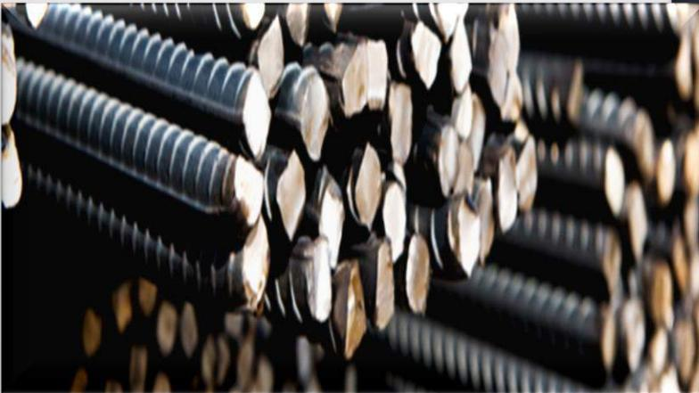
La composición del acero con la cual está hecha **LA CABILLA** está dotada de una gran ductilidad, la cual permite que a la hora de cortar y doblar no sufra daños. La cabilla corrugada tiene unas características técnicas que debe cumplir para asegurar el cálculo correspondiente de las estructuras de concreto armado
