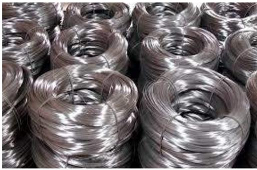
Producto de sección circular, con superficie lisa o estriada, que se obtiene por laminación en caliente de palanquillas. Se usa principalmente para fabricar alambres y mallas electrosoldadas.
