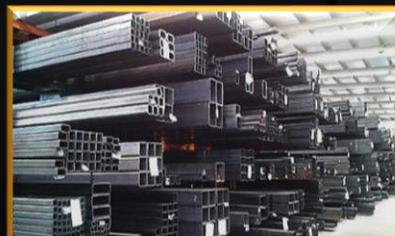
Los Tubos y el Perfil de Acero para Uso Estructural de **INDUSTRIAS UNICON** son fabricados con acero estructural de alta resistencia mecánica conformado en frío y/o soldado eléctricamente por alta frecuencia, formando elementos de **sección circular, cuadrada, rectangular y Correa Z.**
